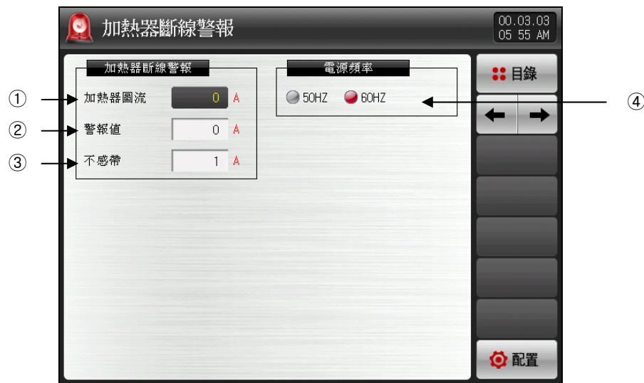
[图17-6]加热器断线警报信号设定画面
