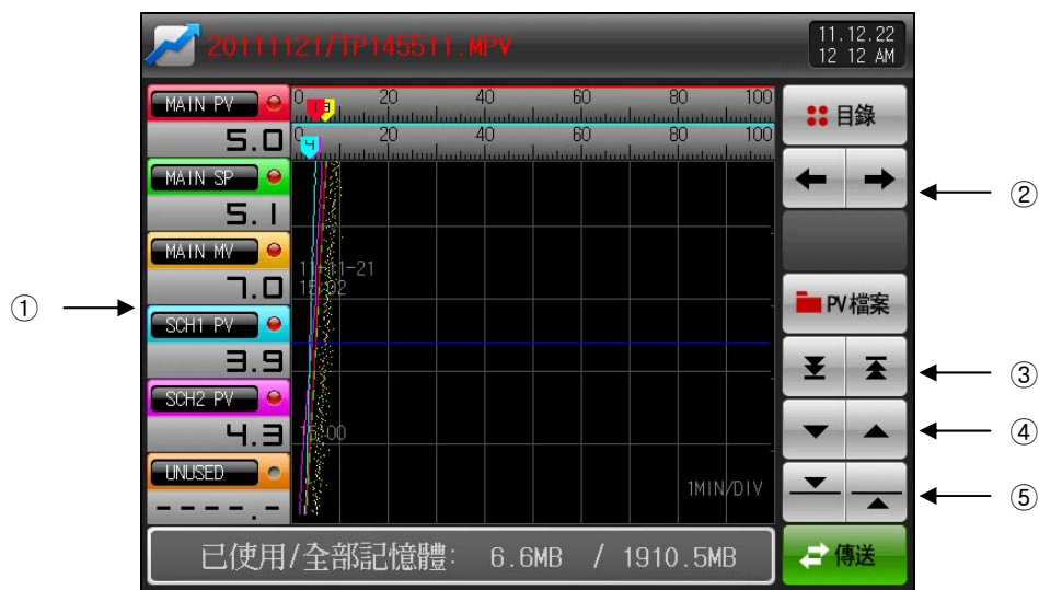
[图6-5] 曲线图&保存设定第2画面(选择曲线图显示)
