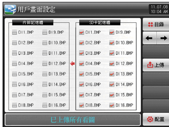
[图 19-10]DI错误发生时显示照片设定画面-3
