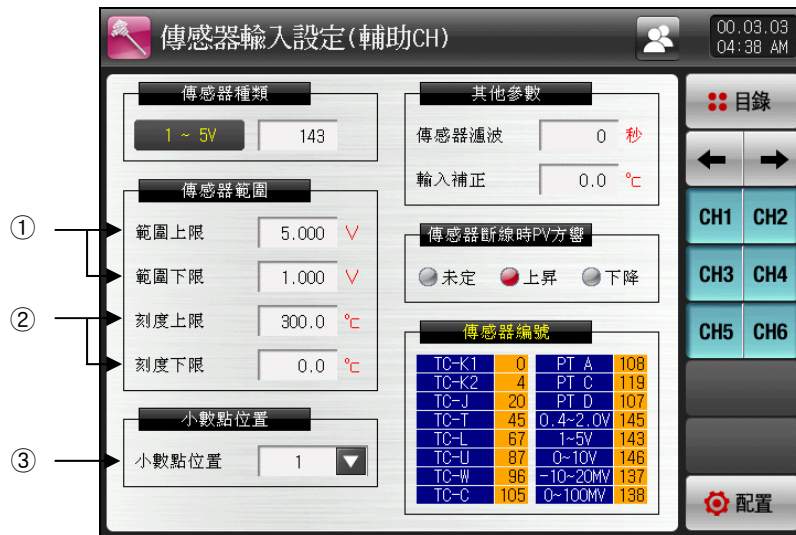
[图22-6] 辅助频道传感输入设定 (DCV设定时)
