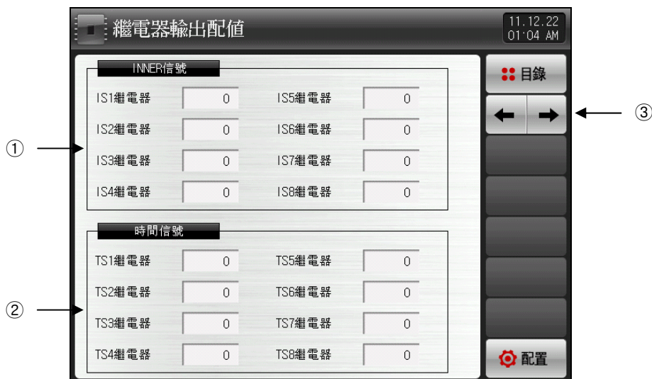
[图13-1]内部信号/时间信号继电器设定画面
