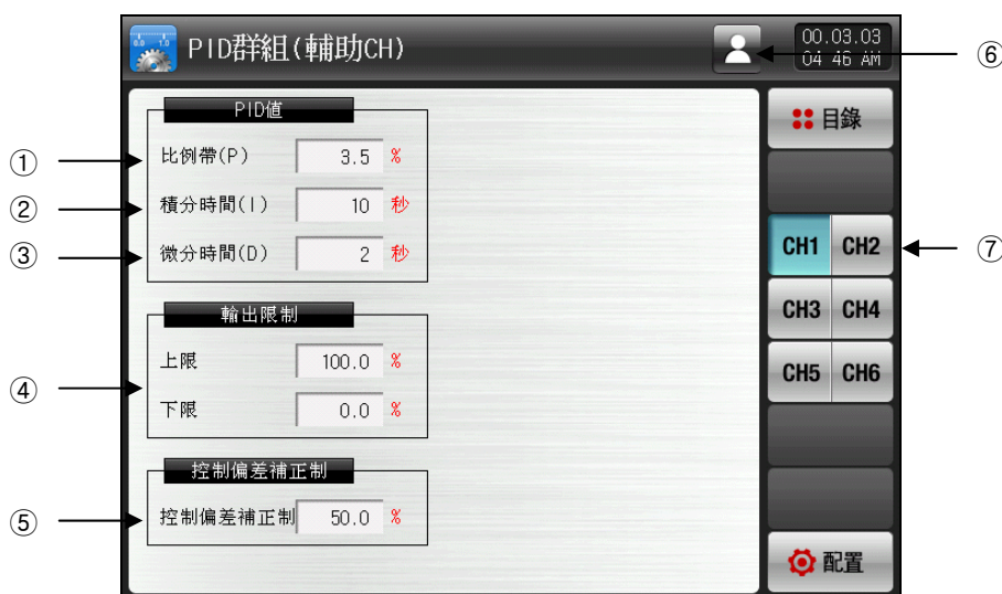
[图22-22] 辅助频道PID组合设定画面-1
