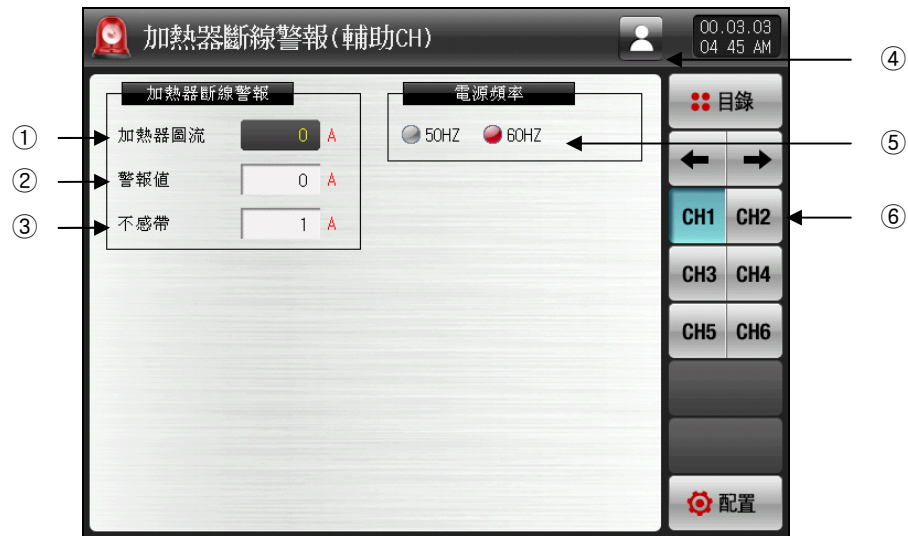
[图22-20]加热器断线警报信号设定画面-1
